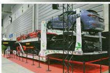
イタリアメーカーであるロルフォは1軸のキャリアカー「Blizzard J1」を展示。トランクウェブの提案から共同開発された、日本市場に適応したモデルとなっている。トラクタのエンジンを止めても付属のバッテリーで各部を動かすことが可能な仕様となっている。
