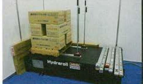
パレット積みトラッカー専用達メークー、ジョロダ社のブースでは、従来の鉄製に比べ約5kgの軽量化を実現する新型アルミスケートを展示。なお1セットあたりの許容耐荷重は1600kg、リフト上昇高は17mmだ。詳細は正規代理店の日本ボーバーツ工業へ。
